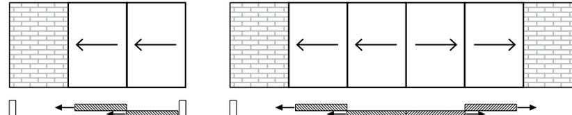
**Telaio scorrevole interno muro con una guida e con due guide di scorrimento**
