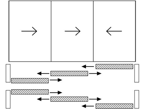
NOTA: Per lo schema con entrambe le ante apribili è possibile utilizzare un'anta ad apertura motorizzata ed un'anta ad apertura manuale oppure entrambe le ante motorizzate.
